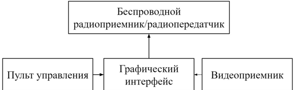
Рисунок 3.5 – Блок-схема наземной станции
